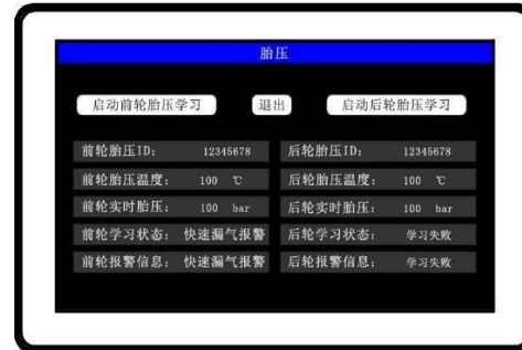
LASTİK BASINÇ ÖLÇÜM SİSTEMİ(TPMS) ARAYÜZÜ
